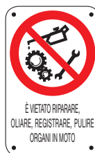
È VIETATO RIPARARE, OLIARE, REGISTRARE, PULIRE ORGANI IN MOTO 19600 P A B
